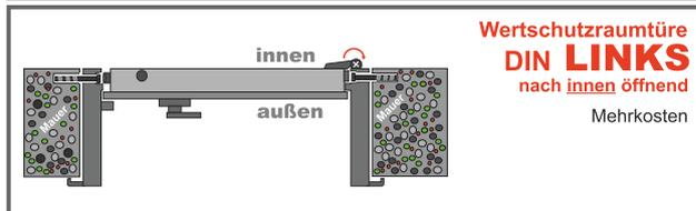
Standardausführung: Der umlaufende Abdeckrahmen beträgt 50 mm, d.h. die Gesamtbreite der Zarge wächst außen um 100 mm und die Gesamthöhe um 50 mm. Dieser Rahmen deckt ungleiche Maueröffnungen ab und stabilisiert die Zarge vor der Verankerung.
