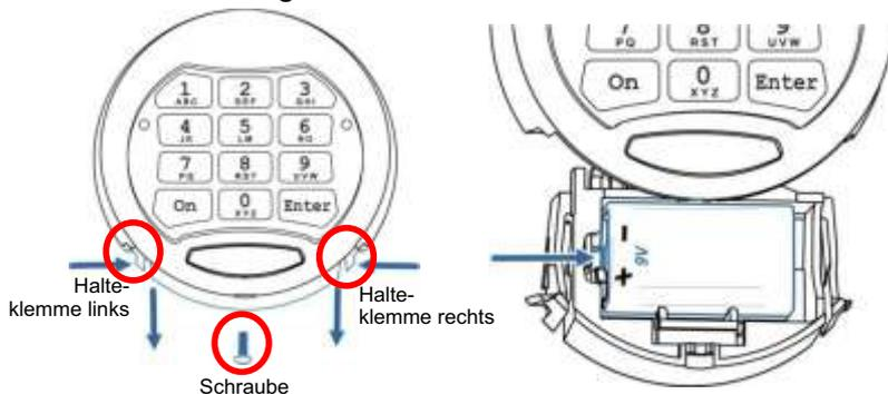
Bitte kleine Schraube lösen und das Batteriefach mittels Lösen der Klemmen links und rechts nach unten ziehen.
