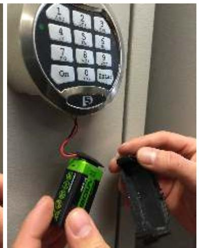
**Bitte nur 9 Volt Block Alkaline mit langer Lebensdauer verwenden. Wir empfehlen sicherheitshalber einmal jährlich die Batterie zu wechseln**
